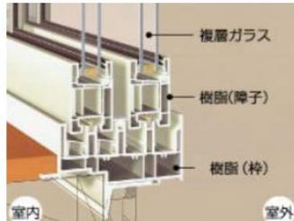
樹脂材料で構成された構造です。断熱性に優れています。
