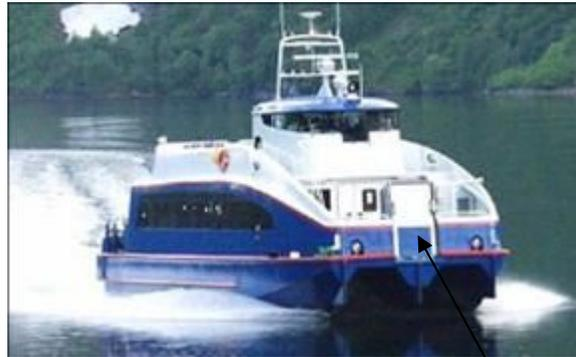
フェリー船体 CFRP
