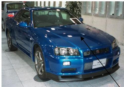
自動車エンジンフード CFRP
