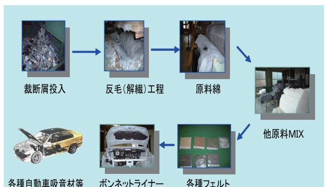
図4：ケミカルリサイクル(左図)・マテリアルリサイクル(右図) フロー図
