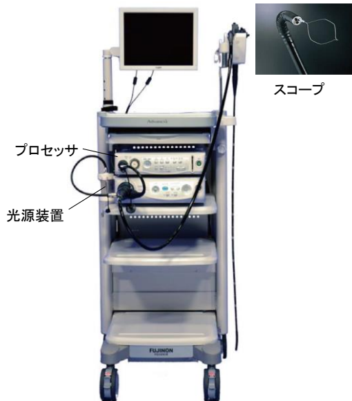
(図 5) 内視鏡のシステム「LASEREO」の構成
