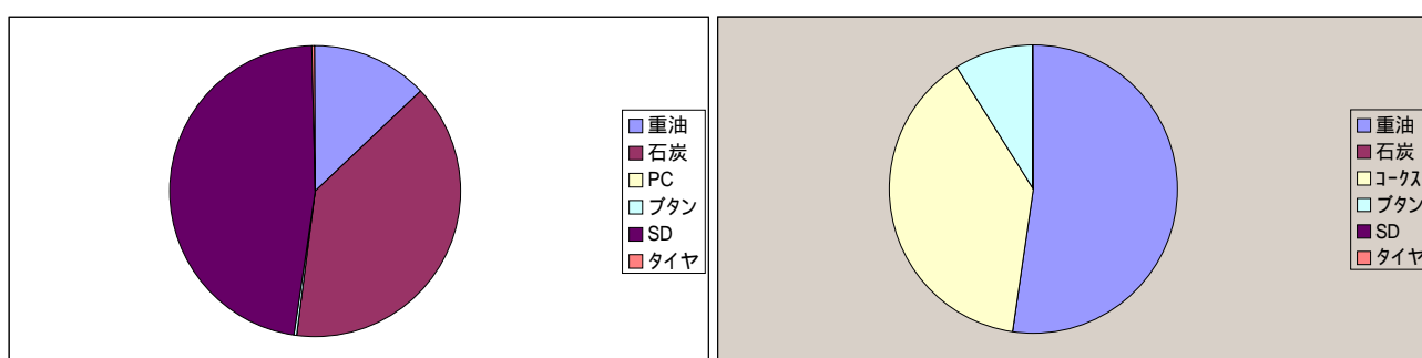
図 2.2.2.5.3 熔錬炉の燃料構成の一例
