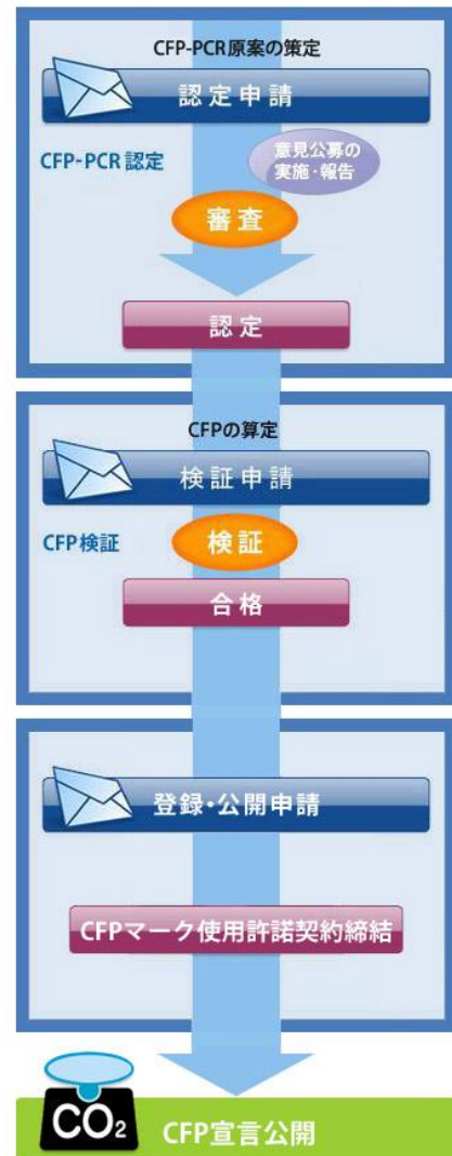
図1 CFPプログラムによるCFPの算定・表示の流れ 2)
